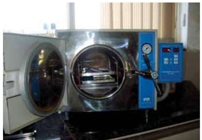
Fig. 5: Autoclave
